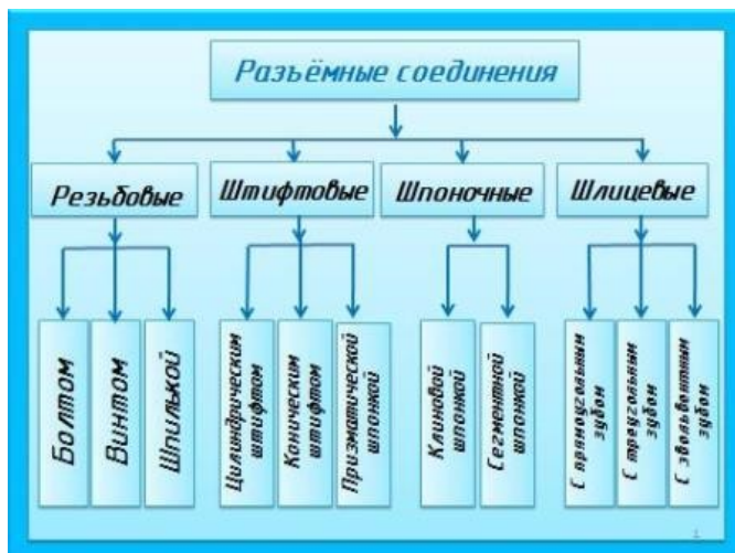
Рис. 113. Основные виды разъемных соединений
