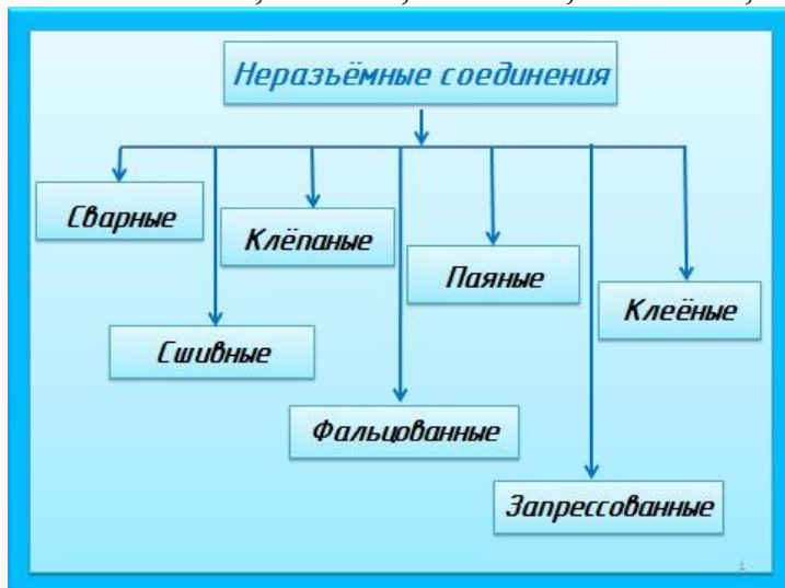
Рис. 114. Основные виды неразъемных соединений
