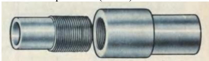
Рис. 117. Наружная (на стержне) и внутренняя (в отверстии) резьба
